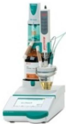
Компактный титратор 915 KF Ti-Touch от Metrohm – еще один титратор уникальной серии Ti-Touch, совмещающий в одном устройстве бюретку, мешалку, дозирующую систему, мембранный насос и сенсорную панель. Несмотря на компактность, титратор 915 KF Ti-Touch обладает широкими возможностями:
